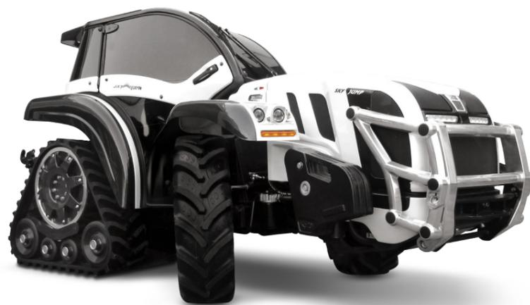
agente sulle ruote anteriori e sullo snodo centrale, lo Sky Jump presenta un'elevata manovrabilità pari a quella dei suoi "fratelli" gommati potendo raggiungere i 60° di angolo di sterzo con raggi di sterzata estremamente contenuti.
